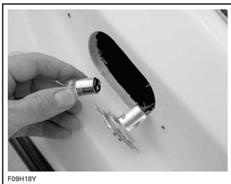
**TYPIQUE — ENFONCER, TOURNER ET RETIRER L'AMPOULE**
