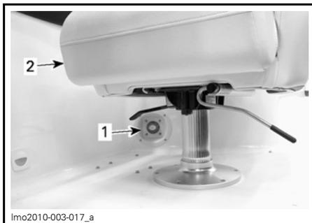
1. Interruptor de desconexión de la batería principal
