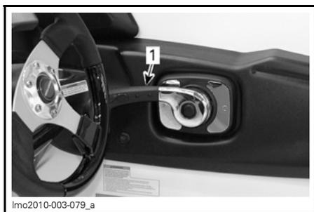
1. Palanca de aceleración / cambio en posición de aceleración total para el avance
