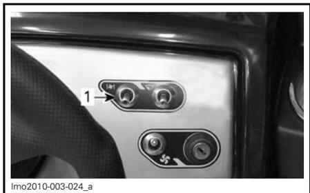
1. Interrupteur du système de chauffage
