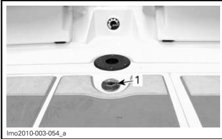
1. Soulever la bague de verrouillage
