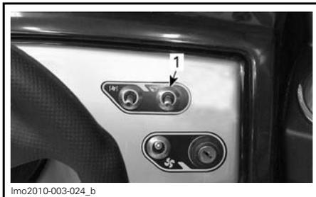
1. Interrupteur de système de lest
