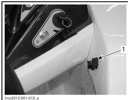
1. Interruptor de desligamento do motor
