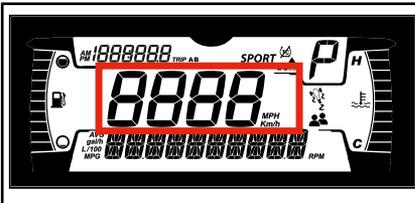
Anzeige der Fahrzeuggeschwindigkeit in km/h oder mph.
