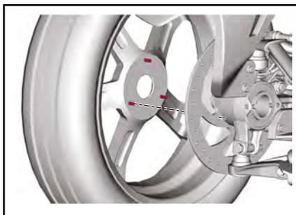
Bringen Sie die Kegelscheibe und die mittlere Radfeststellmutter an. Ziehen Sie die zentrale Radmutter an wie angegeben.
