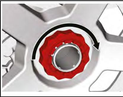
Entfernen Sie die Verriegelungsvorrichtung von der Radnabe.
