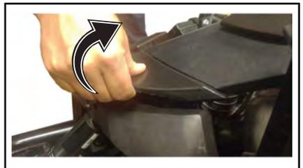
4. Drehen Sie die Schrauben unter der Frontverkleidung ein und ziehen Sie sie nur handfest an.
