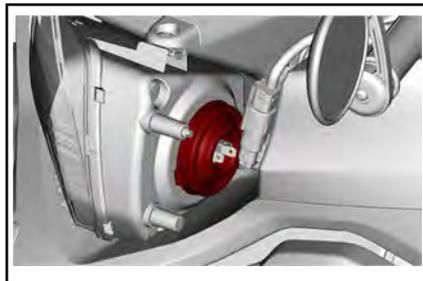
4. Drehen Sie den Glühbirnenstopper entgegen dem Uhrzeigersinn, um ihn zu lösen.
