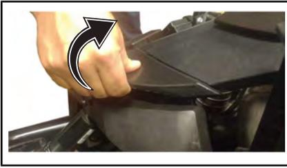
4. Ziehen Sie die Frontverkleidung nach vorne, um sie vom Fahrzeug zu lösen.
