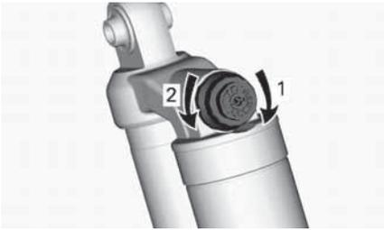
**COMPRESSION DAMPING - TOP OF SHOCK ABSORBER**
