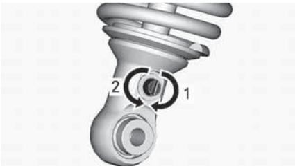
**REBOUND DAMPING - BOTTOM OF SHOCK ABSORBER**
