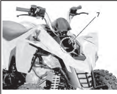
PANEL DE ACCESO DEL GUARDABARRIOS DELANTERO
