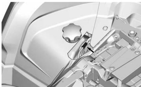
1. Desenchufe las mangueras del filtro por el arco de la rueda trasera derecha.
