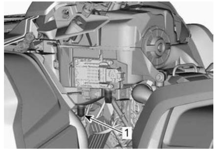
1. Tubo de vaciado del filtro de aire
