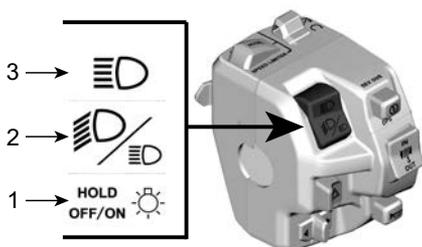
1. Reductor de luz/Faro apagado (OFF)
