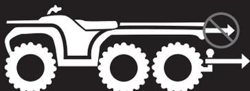
**NE JAMAIS** se fixer ici ou sur la plate-forme pour tirer une charge. Le véhicule pourrait se renverser.
