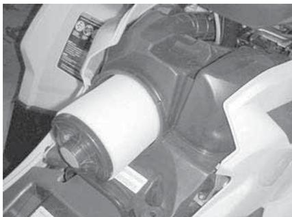
**Untersuchen und Entleeren des Motorluftfilterkastens**
