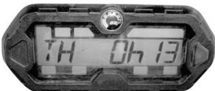
Pressione e SEGURE o botão seletor por 2 segundos para zerar o contador de horas de viagem.
