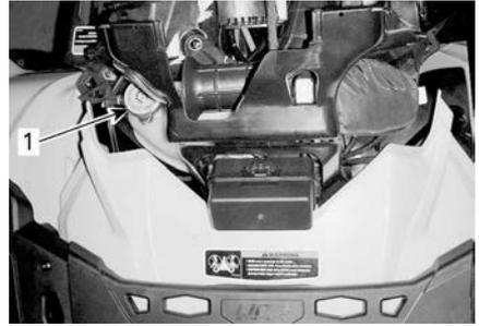
1. Reservatório do líquido de arrefecimento do motor
