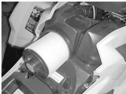
**Inspeção e Drenagem da Caixa do Filtro de Ar do Motor**
