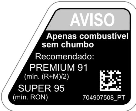
**MOTORES 1000R – PRÓXIMO À TAMPA DO TANQUE DE COMBUSTÍVEL**
