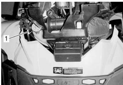
1. Tampa do reservatório de líquido de arrefecimento do motor
