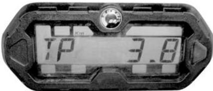
Pressione e SEGURE o botão seletor por 2 segundos para zerar o odômetro parcial.
