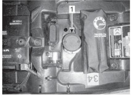
1. Behälter für Bremsflüssigkeit der hinteren Bremse
