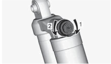
**DRUCKSTUFENDÄMPFUNG - OBEN AM STOßDÄMPFER**
