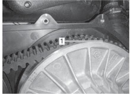
1. Unterster Teil der Zahnäder bündig mit der Außenfläche des Antriebsriemens
