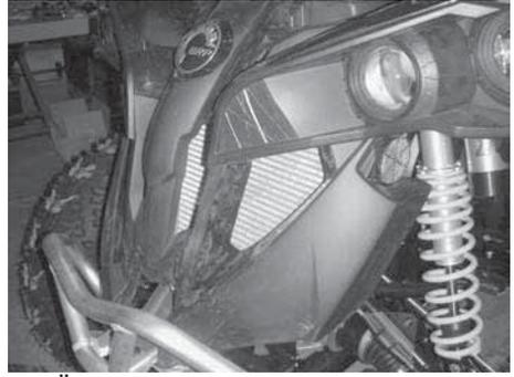
2. Überprüfen Sie den Kühler und die Schläuche auf Undichtigkeiten und andere Beschädigungen.
