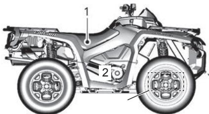
1. Étiquette NIV - Sur le châssis sous le siège
