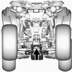
**POINT DE LEVAGE ARRIÈRE****Soulever le véhicule entier**
