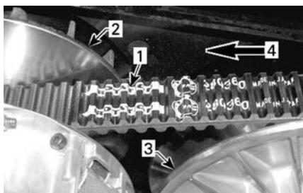
1. Flèche imprimée sur la courroie
