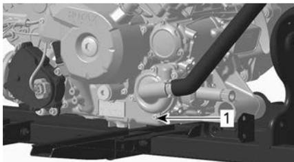
1. Bouchon de vidange du liquide de refroidissement
