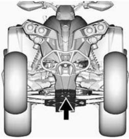
**POINT DE LEVAGE AVANT****Soulever l'arrière du véhicule**
