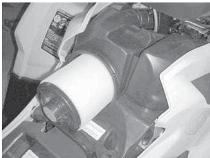
AUSBAU DES LUFTFILTERS
