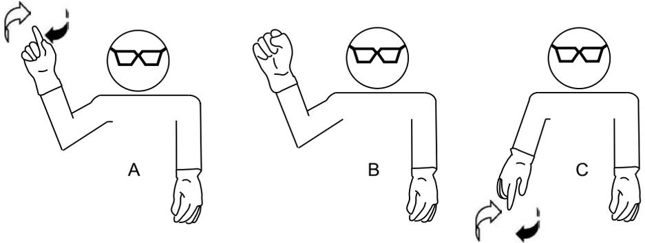
A. Winde einfahren - Zeigefinger und Arm hochhalten, Drehbewegungen mit der Hand machen.
