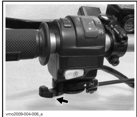
CHOKE IN VOLLSTÄNDIG GEÖFFNETER POSITION
