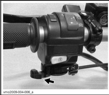
**CHOKE IN VOLLSTÄNDIG GEÖFFNETER POSITION**
