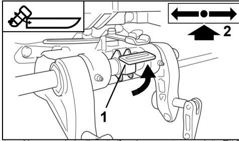
1. Alavanca de inclinação/função – posição TILT (INCLINAR)
