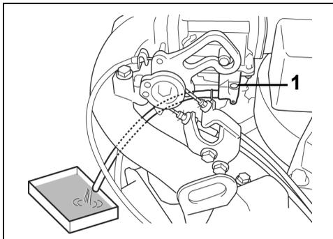
1. Parafuso de drenagem do carburador
