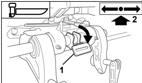
1. Alavanca de inclinação/função – posição RUN (FUNCIONAMENTO)
