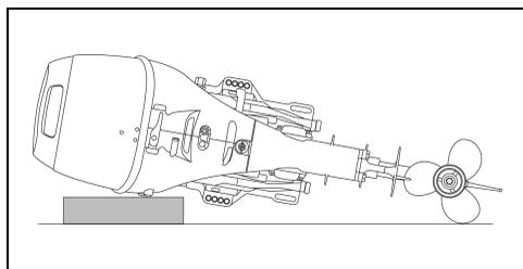
**IMPORTANTE:** Não deixe a caixa de engrenagens do motor fora de bordo ficar acima da cabeça de bomba durante o transporte ou armazenagem. A água pode entrar para a cabeça de bomba e danificar o motor.
