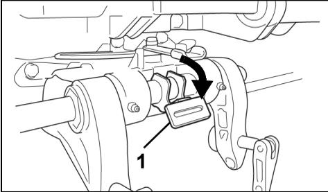
1. Alavanca de bloqueio de inclinação na posição LOCK
