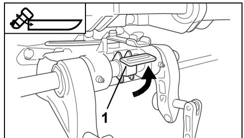
1. Alavanca de bloqueio de inclinação na posição TILT (INCLINAR).
