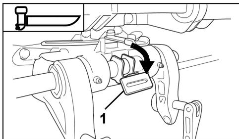
1. Alavanca de inclinação/funcionamento – posição RUN (FUNCIONAMENTO)
