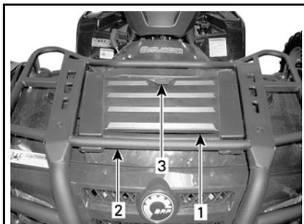
1. Pannello del vano anteriore per la manutenzione
