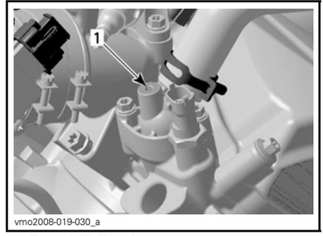
1. Foro dell'alloggiamento termostato
