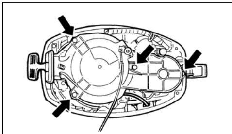
Faire un nœud à l'une des extrémités du cordon de démarrage de secours. Enfiler la petite barre contenue dans la trousse d'outillage à moitié dans l'un des nœuds pour s'en servir comme poignée.
