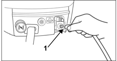
1. Flexible de carburant branché au raccord de carburant
