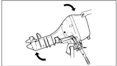
Abaisser lentement le moteur jusqu'à ce que le support pour navigation en eau peu profonde repose contre la tige de réglage d'angle.
