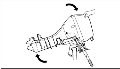
Faire passer le levier de verrouillage de relevage en position de DÉVERROUILLAGE.
