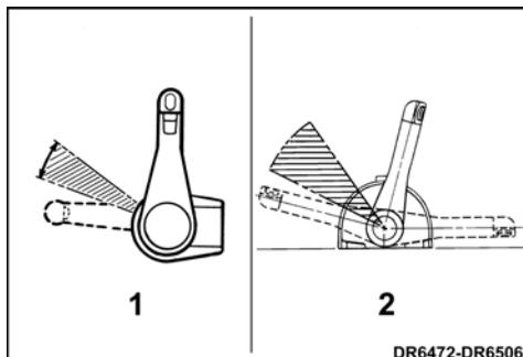
1. Commande encastrée montée sur le côté
