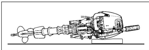
**IMPORTANT** : Ne pas laisser le boîtier d'engrenages du moteur hors-bord reposer plus haut que le bloc-moteur lors du transport ou du remisage. De l'eau risquerait de s'écouler dans le bloc-moteur, ce qui endommagerait le moteur.
