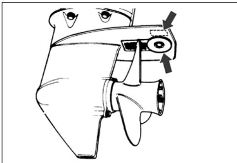
La corrosion galvanique détruit les pièces métalliques immergées et peut se produire aussi bien dans l'eau douce que dans l'eau salée ; cependant les eaux salées, saumâtres et polluées accélèrent la corrosion.
