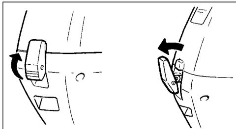
Retirer les boulons maintenant le démarreur à cordon en place.
