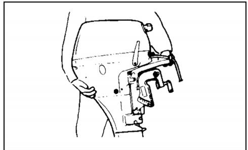
La plaque antiventilation doit alors être entre 0 et 1 po (0 et 25 mm) en dessous de la carène.
