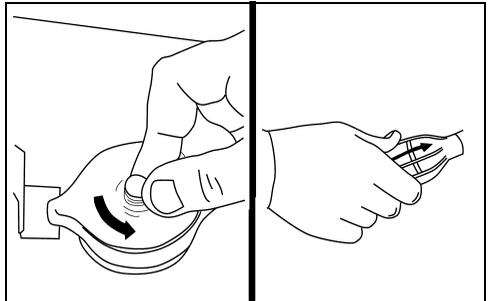
Suivant le modèle, accrocher l'ensemble attache et cordon à l'interrupteur d'arrêt d'urgence. Attacher le cordon à une partie **résistante** des vêtements ou du gilet de sauvetage.
