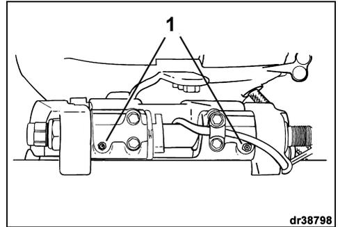
1. Points de lubrification du tube de relevage.
