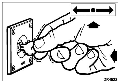
**IMPORTANT** : Le démarreur peut être endommagé s'il est actionné continuellement pendant plus de 10 secondes.
