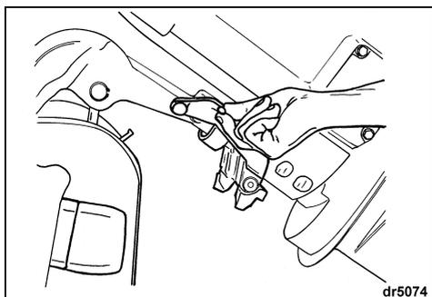
Transporter le bateau avec le moteur en position verticale. Si la remorque n'offre pas une garde au sol suffisante, le moteur peut être transporté en position relevée en se servant de son support pour transport sur remorque.
