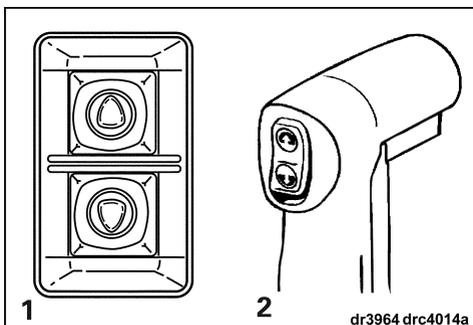
1. Interrupteur de relevage pour transport sur remorque
