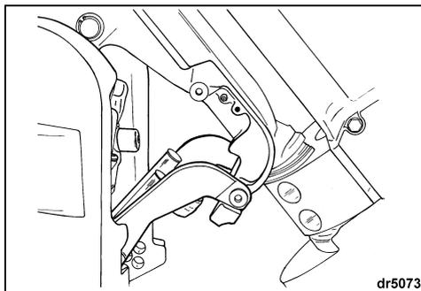
**Pour désengager le support** — Relever complètement le moteur. Ramener le support pour transport sur remorque dans sa position de repos. Abaisser le moteur en position verticale.
