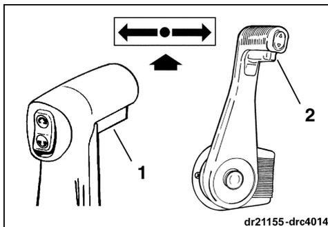
1. Manette de languette de verrouillage au POINT MORT de poignée montée sur le côté
