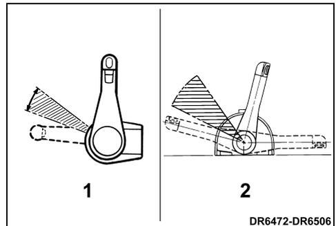
1. Commande encastrée montée sur le côté
