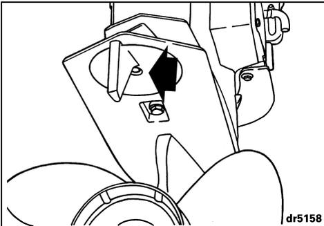
Resserrer la vis du compensateur de dérive à un couple de 35 à 40 lb-pi (47 à 54 N·m).
