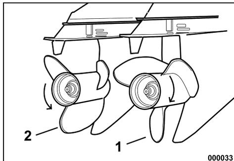
1. Rotation à droite (dans le sens des aiguilles d'une montre)
