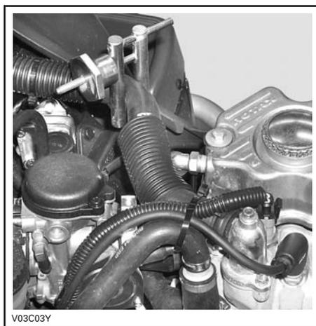
Remplir le radiateur jusqu'à ce que le liquide de refroidissement atteigne l'orifice du logement de thermostat. Installer la vis de purge puis enlever le pince-boyau.
