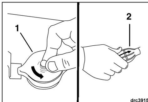
1. Évén à commande manuelle du réservoir de carburant
