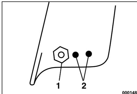
1. Tige de réglage d'angle et écrou de blocage
