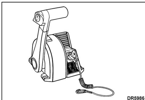
**IMPORTANT** : Lors du passage de MARCHE AVANT en MARCHE ARRIÈRE ou vice versa, marquer une pause au POINT MORT jusqu'à ce que le moteur tourne au ralenti et que la vitesse du bateau ait diminué.
