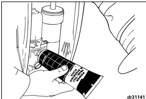
**IMPORTANT** : Un niveau correct de fluide doit être maintenu pour garantir le fonctionnement de la protection contre les impacts intégrée à ce moteur.
