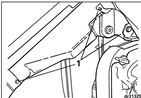
1. Support de relevage bâbord et tribord, support pivotant
