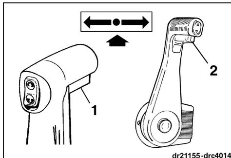
1. Manette de languette de verrouillage au POINT MORT de poignée montée sur le côté
