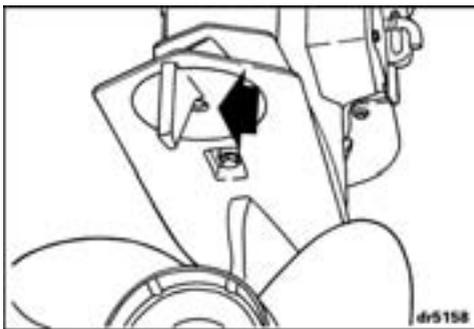
Resserrer la vis du compensateur de dérive à un couple de 24 à 27 N·m (18 à 20 lb·pi).
