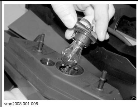
Drücken Sie auf die Glühlampe und halten Sie sie in dieser Stellung, während Sie sie durch Drehen gegen den Uhrzeigersinn lösen.
