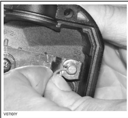
Seitliche Abdeckung vom Drosselklappengehäuse entfernen.
