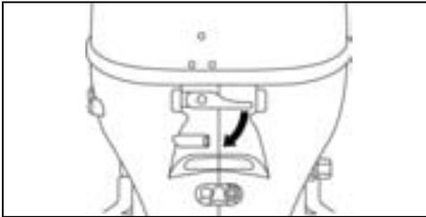
Desserrer l'écrou de blocage. Retirer le câble de support. Séparer l'extrémité du câble de la came.
