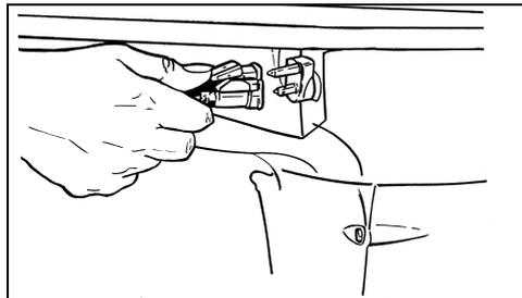
1. Flexible de carburant branché au raccord de carburant
