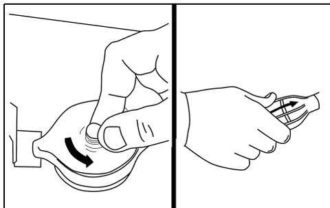
Suivant le modèle, accrocher l'ensemble attache et cordon à l'interrupteur d'arrêt d'urgence. Attacher le cordon à une partie **résistante** des vêtements ou du gilet de sauvetage.
