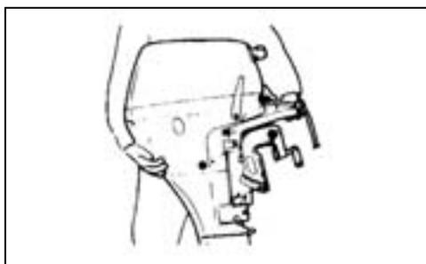
La plaque antiventilation doit alors être entre 0 et 25 mm (0 et 1 po) en dessous de la carène.
