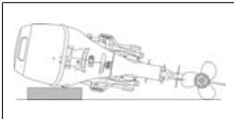
**IMPORTANT** : Ne pas laisser le boîtier d'engrenages du moteur hors-bord reposer plus haut que le bloc-moteur lors du transport ou du remisage. De l'eau risquerait de s'écouler dans le bloc-moteur, ce qui endommagerait le moteur.
