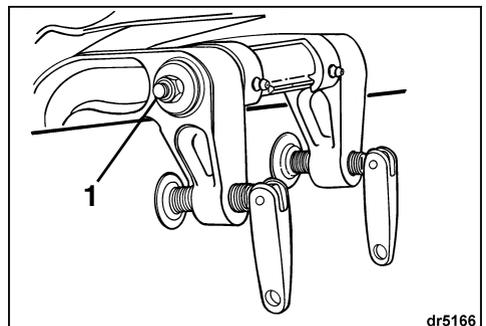
1. Écrou de friction de relevage
