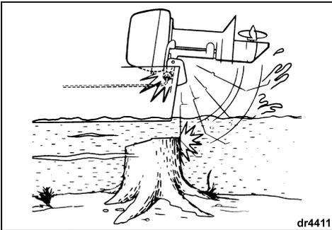
Le système d'amortissement du moteur ne fonctionne pas en marche arrière. Si l'on heurte un objet en reculant, que ce soit dans l'eau ou lors du transport sur remorque, le bateau et le moteur peuvent être gravement endommagés.
