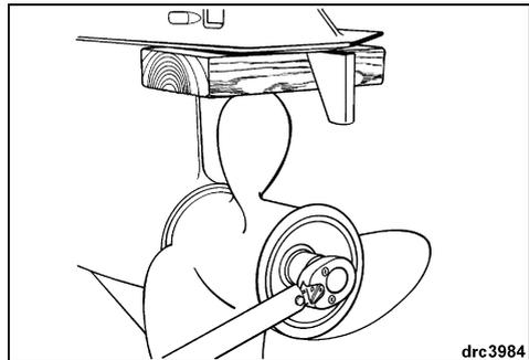
Remettre l'écrou d'hélice et bien le serrer.
