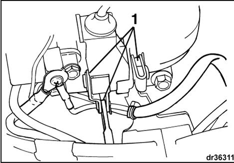
1. Axe et dispositif de blocage de levier de sens de marche
