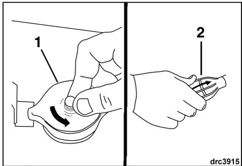
1. Évent à commande manuelle du réservoir de carburant
