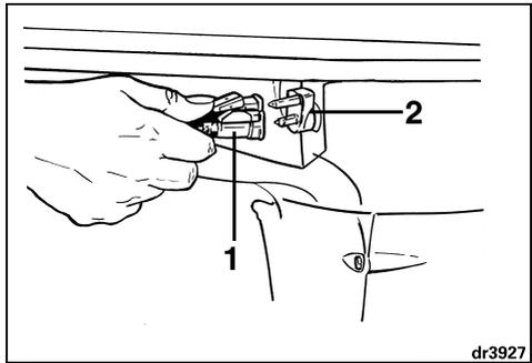
1. Raccord de flexible de carburant
