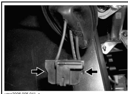
**SPingere LA LINGUETTA DI BLOCCAGGIO PER SBLOCCARE IL CONNETTORE**
