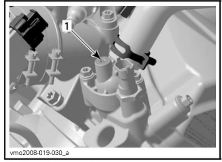
1. Foro dell'alloggiamento termostato
