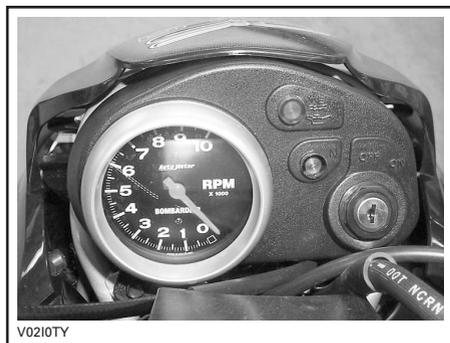
Er zeigt die Motorumdrehungen pro Minute (RPM) an. Multiplizieren Sie den angezeigten Wert mit 1000, um den ungefähren tatsächlichen Drehzahlwert in U/min zu erhalten.
