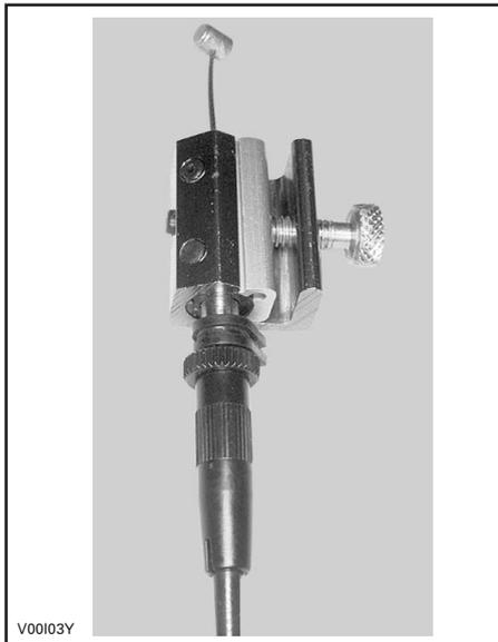
Stecken Sie die Sprühspitze der Sprühdose in die Öffnung des Schmieraufsatzes.
