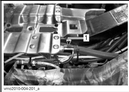
1. Acoplamiento del compresor
