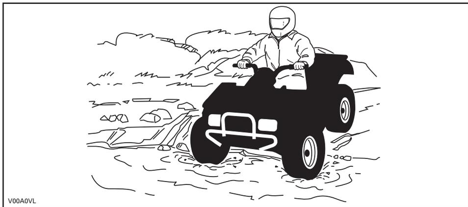
El agua afecta a la capacidad de frenado del vehículo. Asegúrese de que se sequen los frenos; para ello, accíonelos varias veces después de salir del agua con el vehículo.
