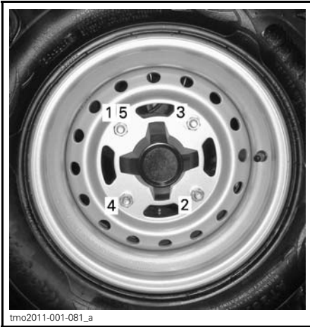
REIHENFOLGE BEIM ANZIEHEN
