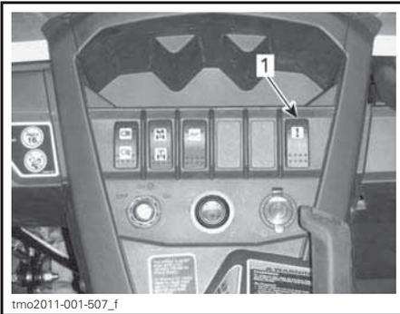
1. Interrupteur de commande de treuil
