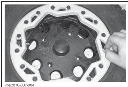
5. Au moyen d'un clé dynamométrique, serrer les vis de talon de verrou à un couple initial de 3 N•m dans un ordre entrecroisé.
