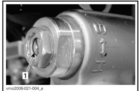
1. Dispositif de réglage de la compression à basse vitesse (tournevis plat)
