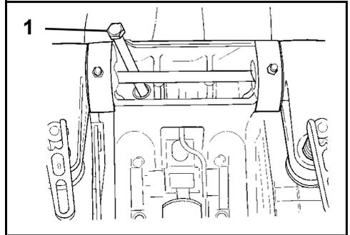
1. Palanca de fricción de la dirección
