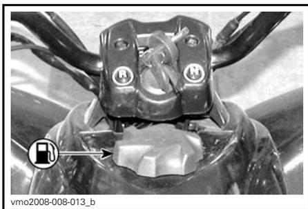
**TYPIQUE — BOUCHON DU RÉSERVOIR
