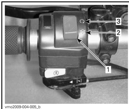
1. Interrupteur d'arrêt d'urgence du moteur
