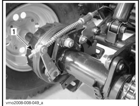
1. Dispositif de réglage de câble de frein
