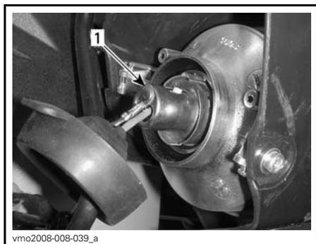
APPUYER SUR LE SUPPORT D'AMPOULE ET LE TOURNER DANS LE SENS ANTIHORAIRE
