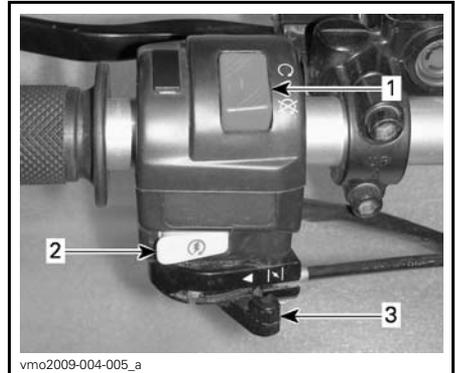
1. Interrupteur d'arrêt d'urgence du moteur
