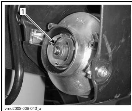
TIRER SUR L'AMPOULE POUR L'EXTRAIRE PUIS LA REMPLACER
