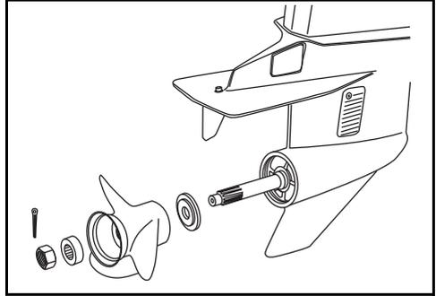
Klemmen Sie einen Holzklötz zwischen Schraubenblatt und Belüftungsschutzplatte.
