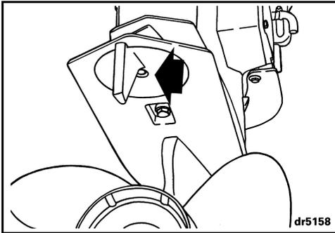
Resserrer la vis du compensateur de dérive à un couple de 47 à 54 N·m. Effectuer un essai du bateau et, si nécessaire, répéter l'opération jusqu'à ce que l'effort de direction soit aussi uniforme que possible.
