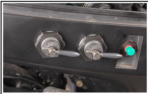
**IMPORTANT** : NE PAS faire fonctionner le moteur hors-bord avec les vannes de vidange en position DRAIN pendant plus de 3 minutes, sous peine d'endommager le moteur.
