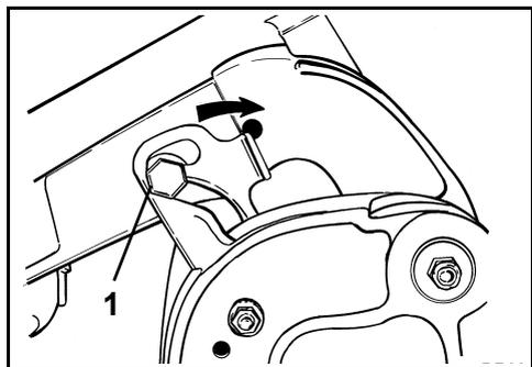
1. Support de relevage – position de déverrouillage
