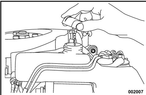
Remettre le bouchon de remplissage en place et bien le serrer. Remettre en place le capot moteur.
