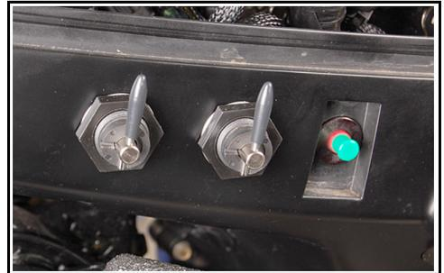
Relever le moteur hors-bord jusqu'à sa position maximale et le basculer de sorte que les vannes de vidange soient en bas.
