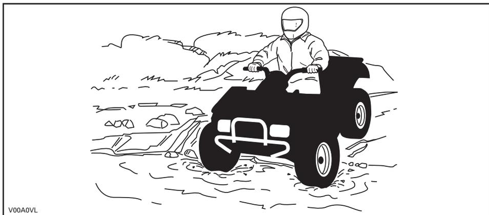
El agua afecta a la capacidad de frenado del vehículo. Asegúrese de que se sequen los frenos; para ello, accíonelos varias veces después de salir del agua con el vehículo. En modelos 2-UP, la distancia de frenado puede verse afectada si se lleva un pasajero. Reduzca prudentemente la velocidad cuando lleve un pasajero. Tenga en cuenta la necesidad de una mayor distancia para el frenado.
